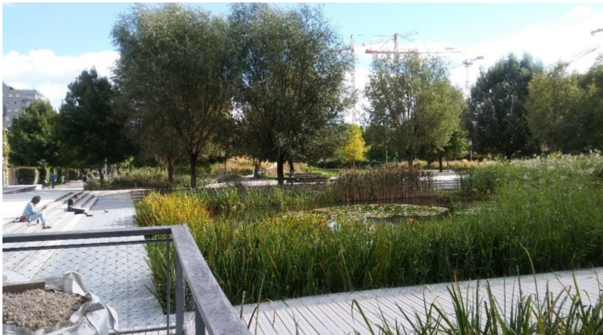
Obr. 74: Zberné jazierka zrážkovej vody na verejnom priestranstve
