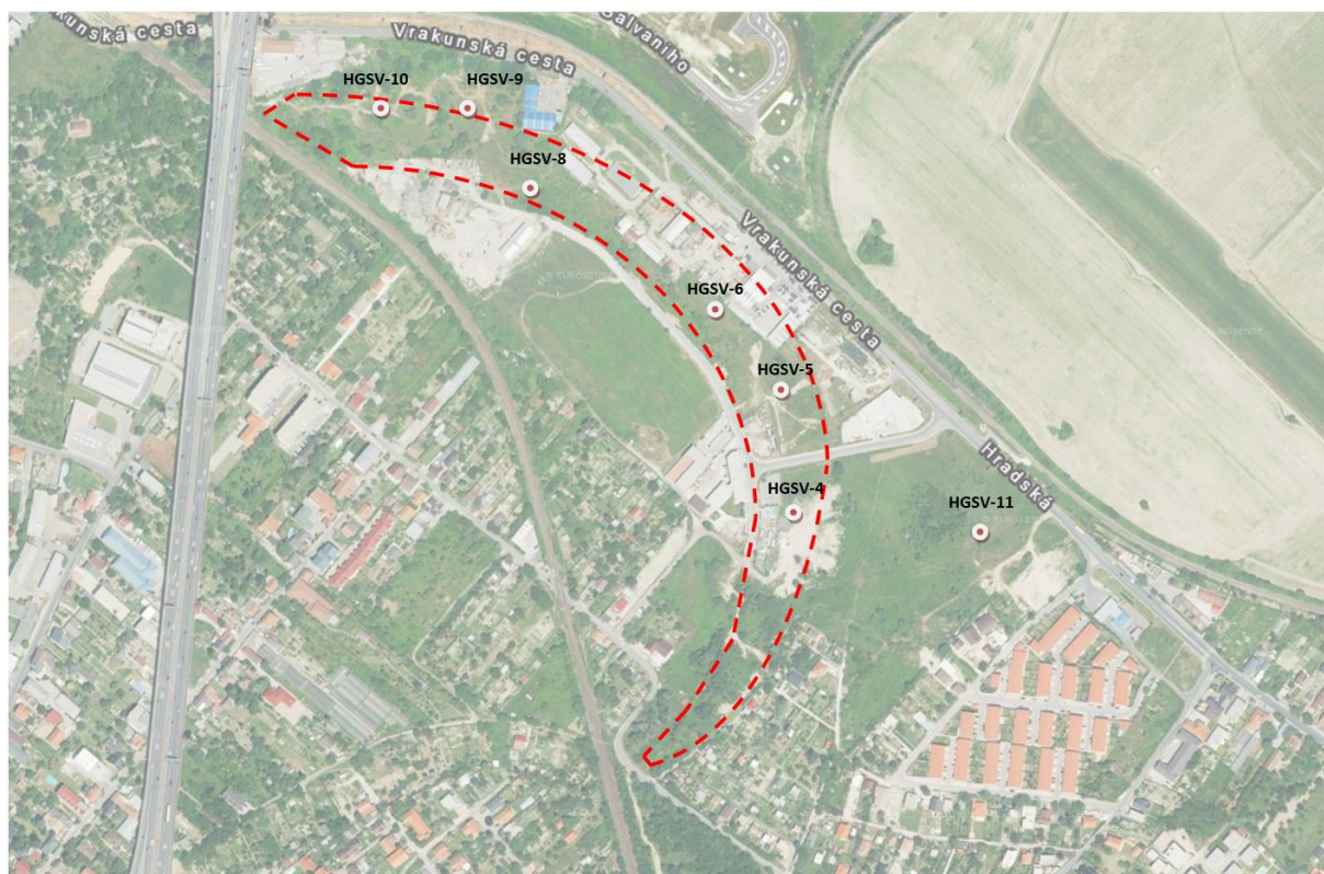
Obr. 3. Monitorovacie objekty HGSV-4 – HGSV-11 lokalizované v telese bývalej skládky CHZJD. Jedná sa hydrogeologické vrty vybudované v rámci geologického prieskumu environmentálnej záťaž Vrakunská cesta – skládka CHZJD – SK/EZ/B2/136, ktorý realizovala spoločnosť DEKONTA Slovensko, spol. s r. o.
