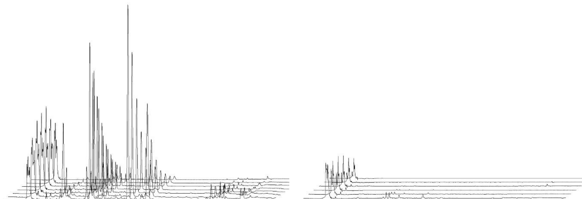
Obr. 34. Zmena koncentrácie znečisťujúcich látok vo vzorke vody z vrtu HGSV-10 počas elektrochemického spracovania vody. Obr. vľavo: HPLC chromatogramy vzoriek odoberaných počas prvých 60 minút elektrolýzy. Vzorky boli odoberané v 10- minútových intervaloch. Obr. vpravo: HPLC chromatogramy vzoriek odoberaných v čase od 60 do 180 minút poukazujú na pokračovanie rozkladu až do úplného vymiznutia jednotlivých látok. Vzorky boli odoberané v 20 minútových intervaloch.
