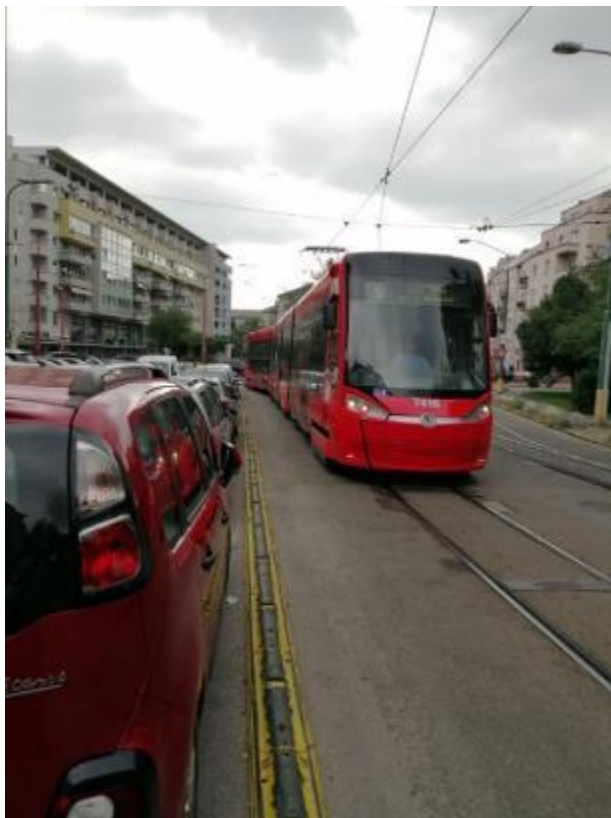
Obrázok 5-1 Ochrana električkového telesa vodiacim prahom (Zdroj: Spracovateľ)
