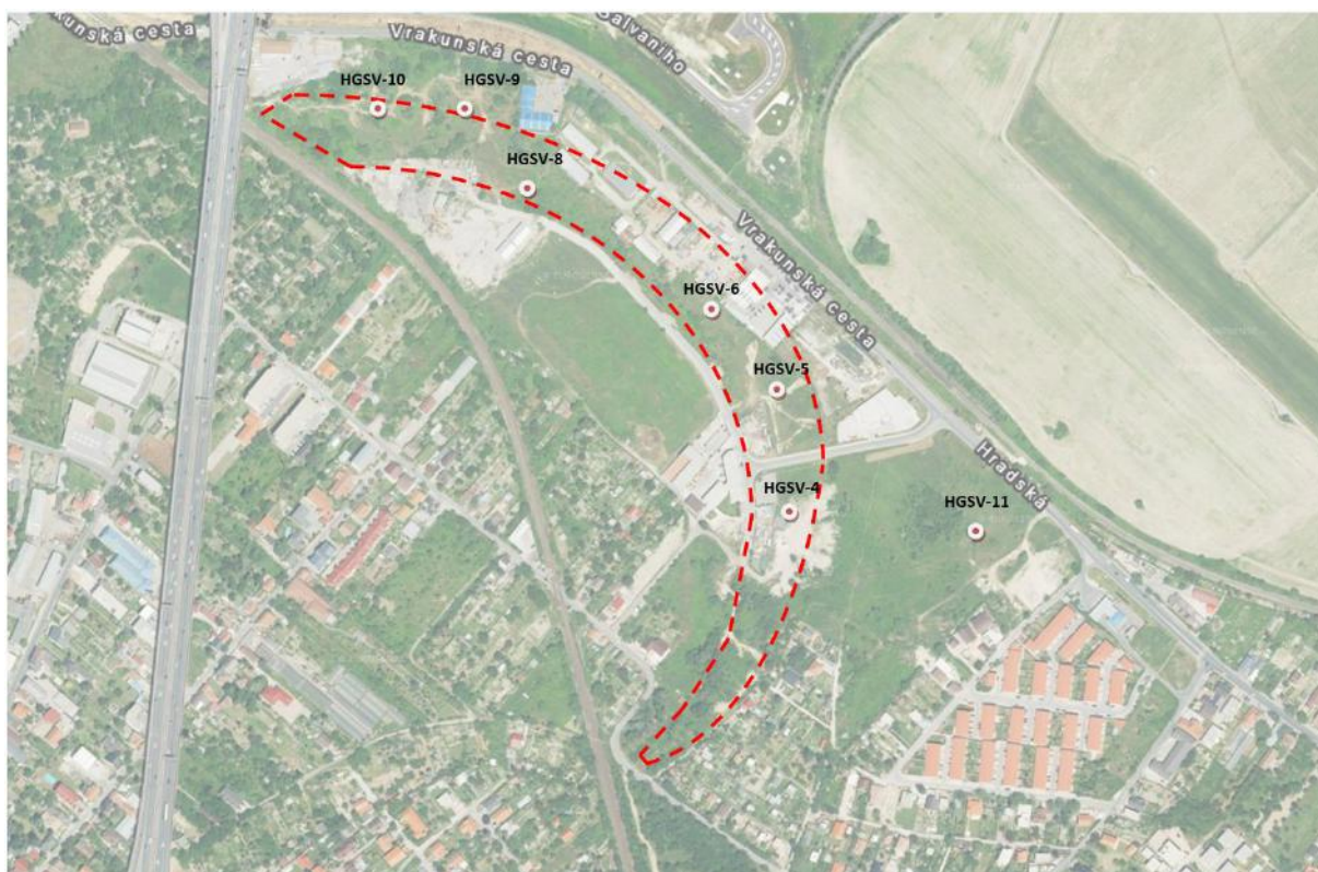
Obr. 3. Monitorovacie objekty HGSV-4 – HGSV-11 lokalizované v telese bývalej skládky CHZJD. Jedná sa o hydrogeologické vrty vybudované v rámci geologického prieskumu environmentálnej záťaž Vrakunská cesta – skládka CHZJD – SK/EZ/B2/136, ktorý realizovala spoločnosť DEKONTA Slovensko, spol. s r. o.
