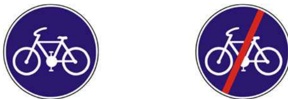
Obrázok 1 - Zvislé dopravné značenie – začiatok C8 a koniec C18 samostatnej cyklistickej cestičky. (16)
