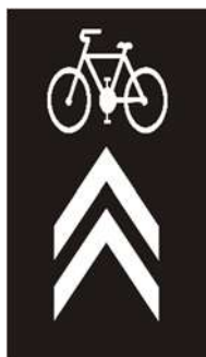
Obrázok 5 - Vodorovné dopravné značenie V 8c vyznačujúce cyklopiktokoridor. (16)
