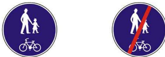
Obrázok 2 - Zvislé dopravné značenie – začiatok C12 a koniec C18 spoločného chodníka pre chodcov a cyklistov. Chodci a cyklisti sú vedení na spoločnej MK bez akéhokoľvek vizuálneho či fyzického oddelenia. (16)
