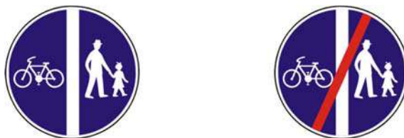
Obrázok 3 - Zvislé dopravné značenie – začiatok C13 a koniec C18 cyklistickej cestičky primknutej k chodníku pre chodcov. Oddelenie chodcov a cyklistov fyzickou prekážkou. (16)
