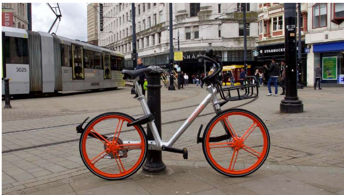
Obrázok 7 – Smart výpožičný bicykel Mobike v Manchesteri, VB. Bicykel je možné uzamknúť prakticky kdekoľvek vďaka zámku na zadnej časti rámu bicykla. Aplikácia v smartfónoch užívateľov informuje kde sa najbližšie bicycle nachádzajú, tiež sprostredkúva odomykanie a zamykanie bicyklov. (18)
