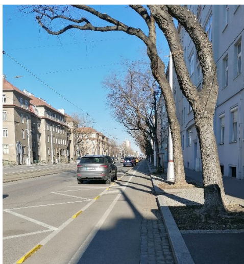
Obr. 2. 14 Vyznačený ochranný pás, ktorý zabráni zraneniu cyklistov otvárajúcimi dverami áut. Zvýšiť bezpečnosť cyklistov je možné iba za predpokladu, že na nich nebudú parkovať motorové vozidlá.
